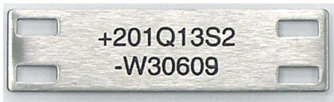
Schildgröße 61x16x1,0mm, Ecken R1 mm gerundet, 4 -Langlöcher 8x3mm, Ausführung **Edelstahl V2A geschliffen (laserbeschriftet)**
