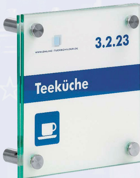
Türschild 150x150 mm, 2 Glasplatten 4,0 mm ESG Glas, 4 Edelstahl Wandhalter
